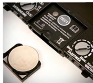
Кнопка «тест» осуществляет проверку работоспособности светофильтра.
