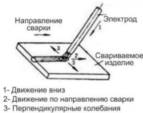
Рисунок 13.4 Три основных направления движения электрода
