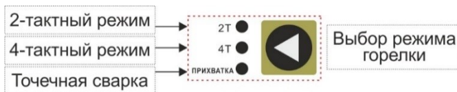
Рисунок 10-5. Описание панели выбора режима горелки.
