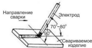
Рисунок 13.5 Угол наклона электрода при сварке в нижнем положении
