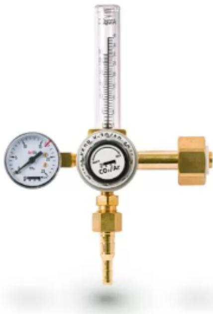
Регулятор расхода КЕДР У-30/АР-40/1 мини с ротаметром и встроенным экономайзером устанавливается на баллон с газом и предназначен для понижения давления, регулирования расхода и экономии защитного газа, подаваемого из магистрали или баллона, и поддержания постоянного заданного расхода при питании постов сварочного оборудования для MIG/MAG и TIG-сварки.
