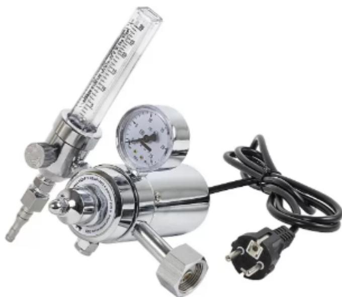
Регулятор расхода КЕДР У-30/АР-40/3 с ротаметром и подогревателем 36В предназначен для понижения давления защитного газа, подаваемого из магистрали или баллона, и поддержания постоянного заданного расхода при питании постов сварочного оборудования для MIG/MAG и TIG-сварки.
