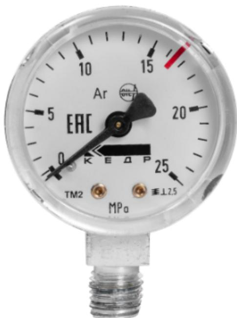
Манометр аргоновый МП-50 (0-25МПа, кл.2,5, М12Х1,5) Ar-У предназначен для измерения давления в сварочных приборах.
