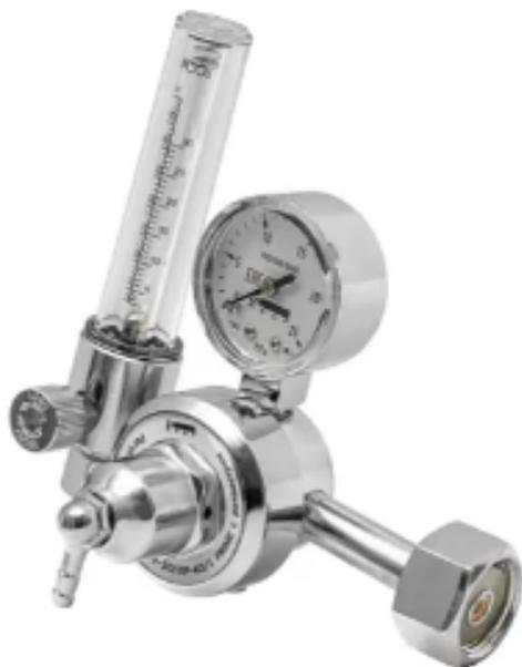
Регулятор расхода КЕДР У-30/АР-40/1 PRIME с ротаметром предназначен для понижения давления защитного газа, подаваемого из магистрали или баллона, и поддержания постоянного заданного расхода при питании постов сварочного оборудования для MIG/MAG и TIG-сварки.
