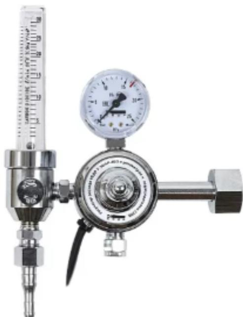
Регулятор расхода У-30/АР-40/3-220 с ротаметром и подогревателем 220В предназначен для понижения давления защитного газа, подаваемого из магистрали или баллона, и поддержания постоянного заданного расхода при питании постов сварочного оборудования для MIG/MAG и TIG-сварки.
