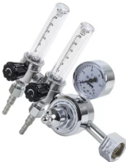
Регулятор расхода КЕДР У-30/АР-40/2 с 2 ротаметрами предназначен для понижения давления защитного газа, подаваемого из магистрали или баллона, и поддержания постоянного заданного расхода при питании постов сварочного оборудования для MIG/MAG и TIG-сварки.
