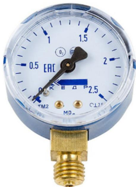
Манометр кислородный МП-50 ТИП-ТМ- 210Р.00 (0-2,5МПа, кл.2,5, М12Х1,5) О2-У КЕДР устанавливается на кислородный редуктор и предназначен для измерения давления в сварочных приборах.
