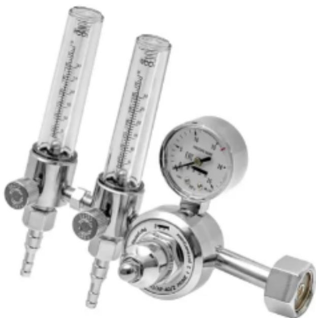
Регулятор расхода КЕДР У-30/АР-40/2 PRIME с 2 ротаметрами предназначен для понижения давления защитного газа, подаваемого из магистрали или баллона, и поддержания постоянного заданного расхода при питании постов сварочного оборудования для MIG/MAG и TIG-сварки.
