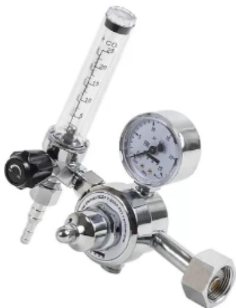
Регулятор расхода КЕДР У-30/АР-40/1, с ротаметром, предназначен для понижения давления защитного газа, подаваемого из магистрали или баллона, и поддержания постоянного заданного расхода при питании постов сварочного оборудования для MIG/MAG и TIG-сварки. Особенности:
