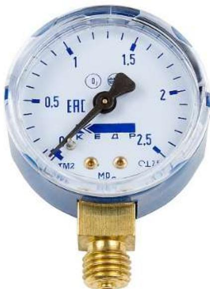
Манометр кислородный МП-50 ТИП-ТМ- 210Р.00 (0-2,5МПа, кл.2,5, М12Х1,5) О2-У предназначен для измерения давления в сварочных приборах. Устанавливается на кислородный редуктор.
