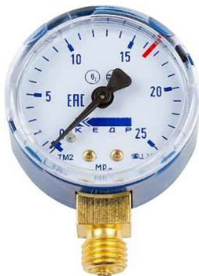
Манометр кислородный ТИП-ТМ -210Р.00 (0-25МПа, кл.2,5, М12Х1,5) ОУ-2 предназначен для измерения давления не агрессивных, не кристаллизующихся жидкостей, пара, газа в т.ч. кислорода.
