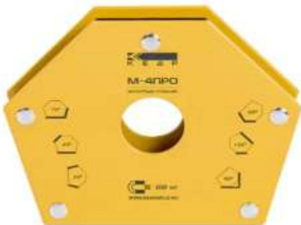
Магнитный угольник М-4 ПРО позволяет производить точное выставление углов в процессе проведения сварочных работ, монтажа стальных конструкций, используется как элемент удержания деталей. Данное приспособление дает возможность осуществлять процесс сварки одному рабочему. Может быть использован для крепления элементов в процессе резки для предотвращения падения частей конструкций.
