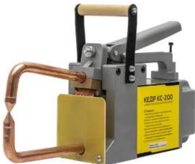
Клещи сварочные КС-200 предназначены исключительно для точечной сварки листов, прутков, проволоки из низкоуглеродистой, углеродистой и легированной стали. Другое использование не допускается.
