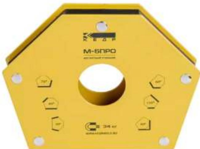
Магнитный угольник М-5 ПРО позволяет производить точное выставление углов в процессе проведения сварочных работ, монтажа стальных конструкций, используется как элемент удержания деталей. Данное приспособление дает возможность осуществлять процесс сварки одному рабочему. Может быть использован для крепления элементов в процессе резки для предотвращения падения частей конструкций.
