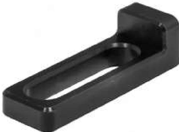
Вертикальный угол КЕДР 90x25 (для Д-16 EXPERT) предназначен для закрепления массивных деталей. Позиционирует детали по вертикали и по горизонтали. Отлично подходит для серийной сборки деталей по шаблону. Благодаря скругленному пазу может устанавливаться в углах деталей, а также на боковых стенках столешницы. За счет применения воронения срок эксплуатации значительно увеличен.
