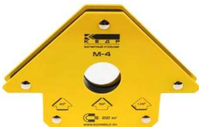
Магнитный угольник М-4 позволяет производить точное выставление углов в процессе проведения сварочных работ, монтажа стальных конструкций, используется как элемент удержания деталей. Данное приспособление дает возможность осуществлять процесс сварки одному рабочему. Может быть использован для крепления элементов в процессе резки для предотвращения падения частей конструкций.
