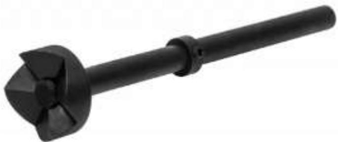
Опора трубная КЕДР предназначена для позиционирования круглой трубы и цилиндрических деталей. Центрирующий шток имеет стопорное кольцо с винтом под шестигранник для фиксации высоты опоры. Исполнение из конструкционной стали с последующим воронением.
