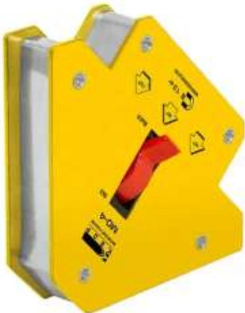
Магнитный угольник МО-4 позволяет производить точное выставление углов в процессе проведения сварочных работ, монтажа стальных конструкций, используется как элемент удержания деталей. Данное приспособление дает возможность осуществлять процесс сварки одному рабочему. Может быть использован для крепления элементов в процессе резки для предотвращения падения частей конструкций.
