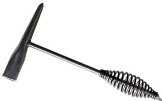
Молоток сварщика шлакоотбойный предназначен для отбивания шлака. С одной стороны молотка-зубило, со второй-острое жало для удаления шлака в корне шва непосредственно в процессе сварки. Пружинная конструкция ручки смягчает отдачу в руку во время удара. Особенности модели:
