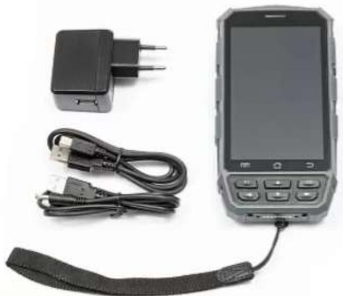
Мобильный пульт сварщика КЕДР КМ представляет собой адаптированный защищенный мобильный интерфейс взаимодействия пользователя (сварщика) с системой мониторинга KEDWELD MANAGER. С помощью мобильного пульта сварщика происходит ручной или автоматизированный (посредством считывания QR-кодов) ввод данных в систему об операторе, сварочном оборудовании, технологической карте, используемых присадочном и защитном материалах.
