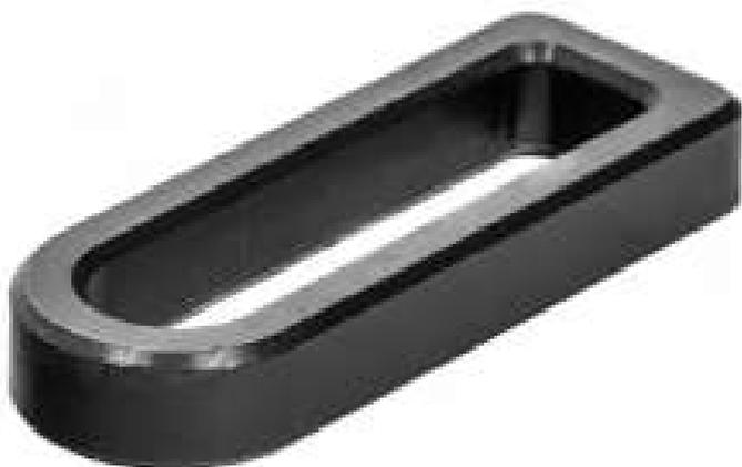
Флекс упор (для Д-16 EXPERT) предназначен для точного и быстрого позиционирования детали на столешнице сварочно-сборочного стола. За счет продольного сквозного паза подходит для позиционирования деталей по шаблону при серийной сборке. Удобен в использовании при недостатке места. Благодаря закругленной внутренней стенке паза может устанавливаться в углах детали. За счет применения воронения срок эксплуатации значительно увеличен.
