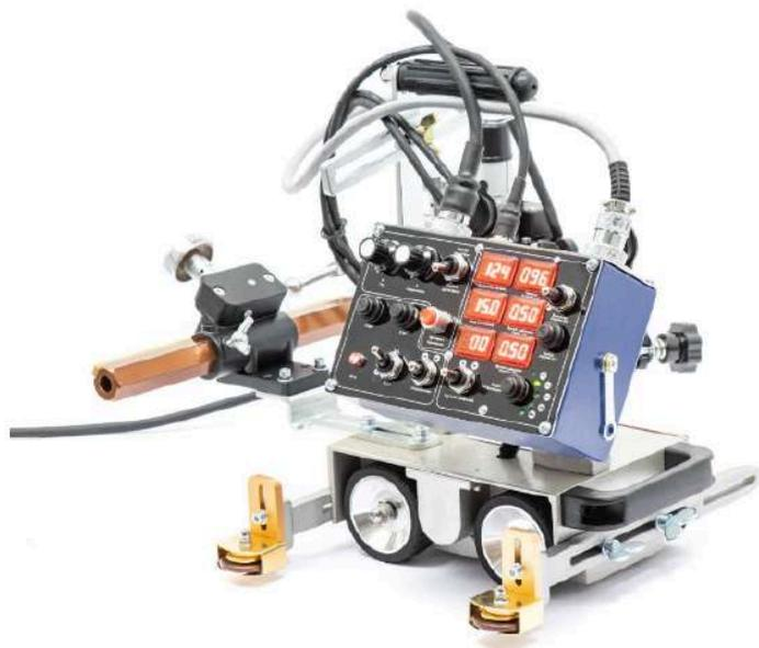
Каретка сварочная КЕДР СК-5 обеспечивает равномерное перемещение горелки с точно заданной скоростью движения и частотой колебаний. Кроме того, она позволяет снизить объемы ручного труда и требования к квалификации сварщиков, уменьшая тем самым количество брака, связанного с человеческим фактором и увеличивая производительности в: 1,5-2,0 раза. Сварочная каретка КЕДР СК-5 совместима с любым сварочным полуавтоматом.
