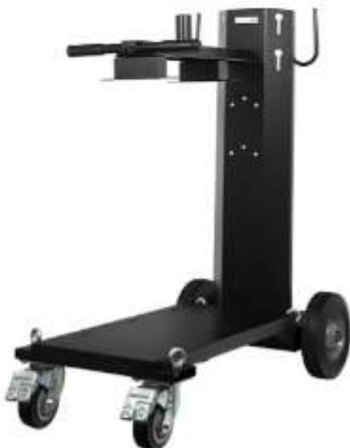
Тележка СТУ-1 для КЕДР MultiMIG-3500/5000S, MultiTIG-3200P DC/3200P AC/DC: прочная тележка для транспортировки аппарата и блока жидкостного охлаждения. Удобна для применения на производственных площадках, в цеховых условиях для перемещения сварочного аппарата в зоне сварки.
