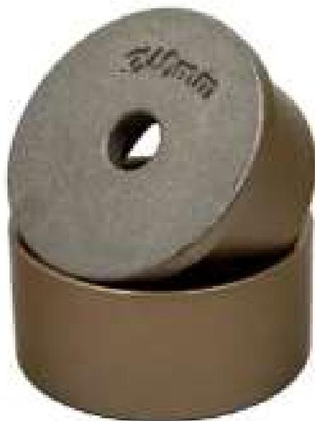
Насадки для сварки пластика КЕДР, диаметр 40 мм, предназначен для сварки полипропиленовых труб и фитингов методом раструбной диффузной сварки. Применяется с аппаратами СП-1000 и СП-1700.
