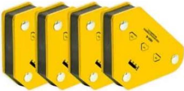
Набор магнитных угольников НМ-4 позволяет производить точное выставление углов в процессе проведения сварочных работ, монтажа стальных конструкций, используется как элемент удержания деталей. Данное приспособление дает возможность осуществлять процесс сварки одному рабочему. Может быть использован для крепления элементов в процессе резки для предотвращения падения частей конструкций.
