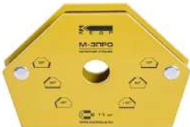
Магнитный угольник М-3 ПРО позволяет производить точное выставление углов в процессе проведения сварочных работ, монтажа стальных конструкций, используется как элемент удержания деталей. Данное приспособление дает возможность осуществлять процесс сварки одному рабочему. Может быть использован для крепления элементов в процессе резки для предотвращения падения частей конструкций.
