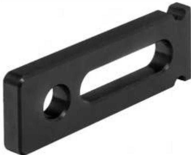
Упор КЕДР 125x40 (для Д-16 EXPERT) предназначен для быстрого и точного позиционирования деталей на сварочно-сборочном столе, отлично подходит для мест с ограниченным доступом, благодаря сквозному пазу и его скругленной форме может устанавливаться в углах деталей и на боковых стенках столешницы. Упор можно использовать со струбциной, продевая ее в отверстие. Исполнение из конструкционной стали с применением воронения.
