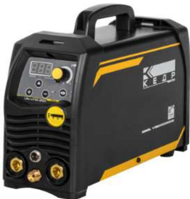
Установка аргодуговой сварки КЕДР UltraTIG-200 (220В, 10-200А) позволяет работать в двух режимах: ручной дуговой сварки (ММА) и аргодуговой сварки (TIG). Данная модель может применяться на небольших производствах, при проведении монтажных работ, а также в небольших мастерских. Сочетание двух технологий сварки и высокой мобильности позволяет использовать его при выполнении комбинированных швов, формируемых в несколько проходов.
