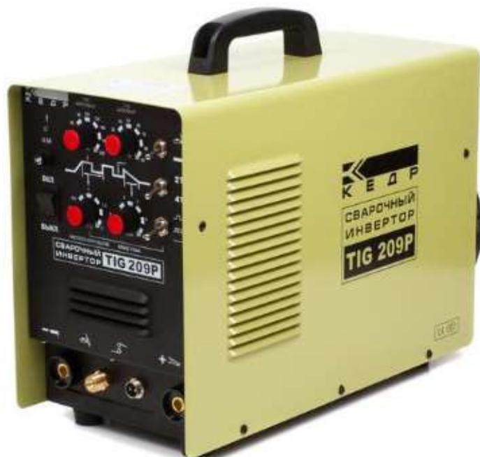
Аппарат аргодуговой сварки КЕДР TIG-209P, DC, 220V предназначена для ручной сварки неплавящимся вольфрамовым электродом углеродистых и легированных сталей, меди, латуни, титана на постоянном токе (TIG DS). Все аппараты имеют возможность подключения дистанционного управления. Инверторы производят сварку методом TIG с высокочастотным поджигом дуги и оснащены газовым клапаном.
